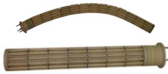
Keramisch Patronenheizkörper Ø 21-57mm, auch biegbar.
